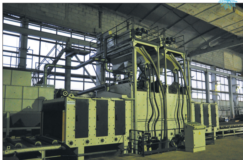
На Великолукском механическом заводе изготовлена дробеметная установка проходного типа, которая по своим техническим характеристикам не уступает зарубежным аналогам
